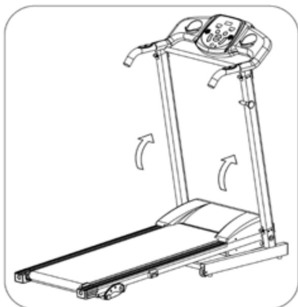
**Стадия 3, 4.** С помощью шестигранника 5 зафиксируйте левую стойку (3) на раме (1) болтом М8\*16 (38), шайбой (52). УТо же самое повторите с правой стойкой. Придерживайте стойки во время установки.
