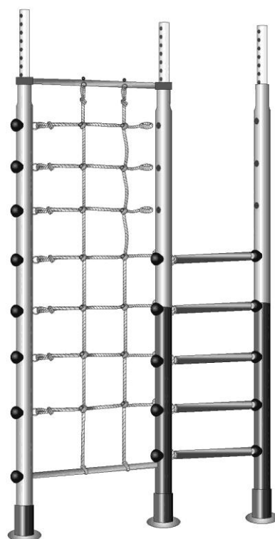
Рис.4 Установка распорных труб
