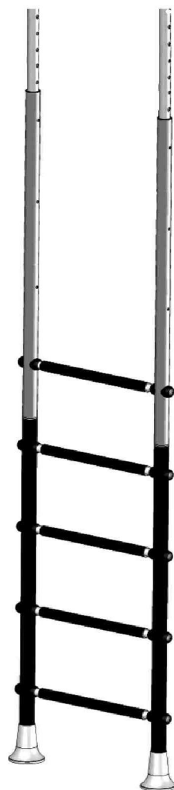
Рис.2 Установка распорных труб
