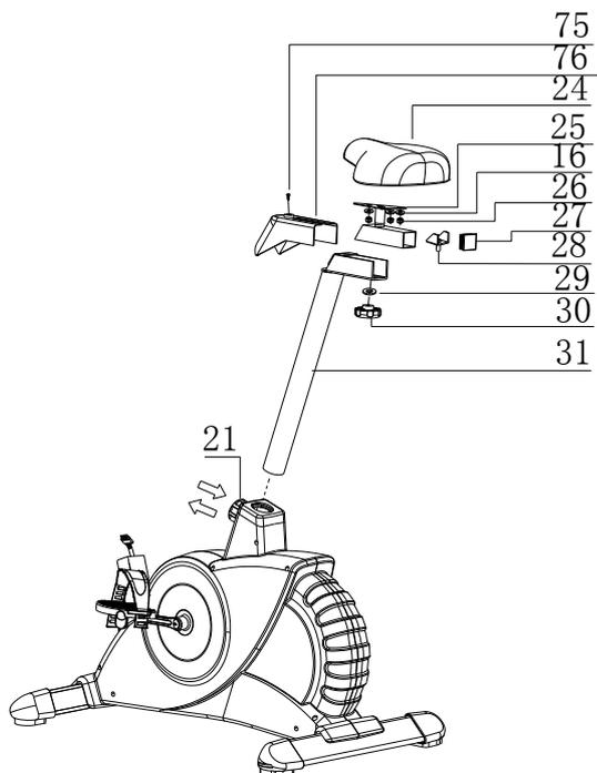
1. Установите сиденье (24) на ползунок (25) с помощью 3 винтов (26) и 3 шайб (16). Затем установите винт и крепко затяните. Закрепите ползунок (25) на стойке сиденья (31) с помощью регулятора и плоской шайбы.
