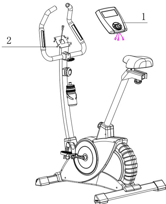
1. Подключите провод датчиков пульса и кабель компьютера.
