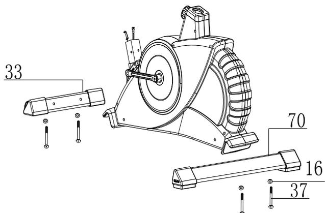
1. Присоедините заднюю опору (70) к основной раме (62) с помощью 2 винтов (37) и 2 шайб (16).
